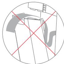
请勿将打印纸拉扯过长并塞入纸仓内。
